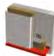
Bas de bardage à larmier
