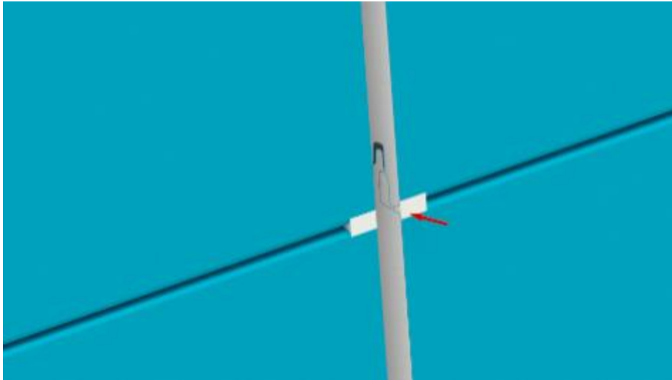
Obturation de l'emboîtement en face extérieure par garnissage de mastic silicone
