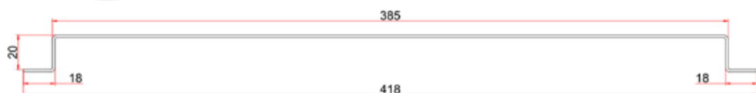
Figure 52 bis – Exemple d'un joint de dilatation dont le déplacement maximal est de 150 mm avec panneau sandwich isolant Louvre en pose horizontale
