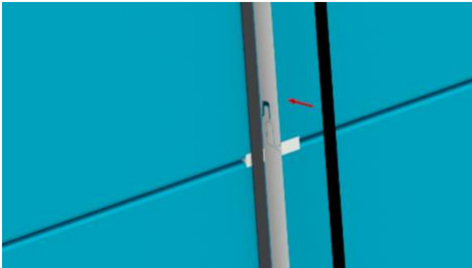
Croisement avec les compléments étanchéités avec mise en place du couvre-joint
