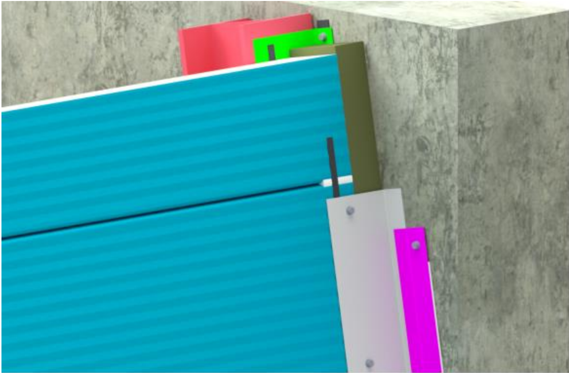
Figure 15 ter – Dispositions complémentaires sur façade inclinée à fruit positif maximal 10° (inclinaison vers l'intérieur) – Rive contre mur
