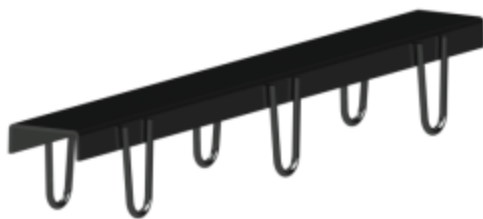
Figure 23 – Exemple d'une jonction verticale en pose horizontale sur ossature béton avec couvre-joint option D
