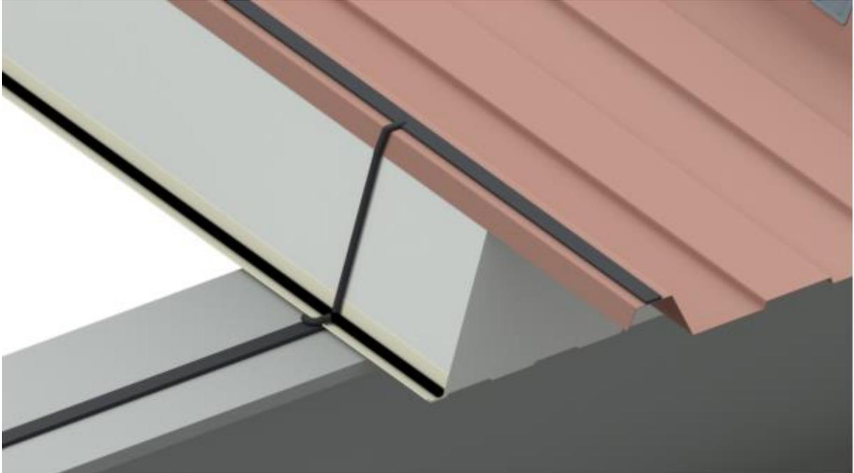
**Figure 6 Bis – Principe de raccordement entre les compléments d'étanchéité longitudinaux et les joints d'étanchéité sur appuis en l'absence de complément d'étanchéité longitudinal extérieur pour les locaux :**
