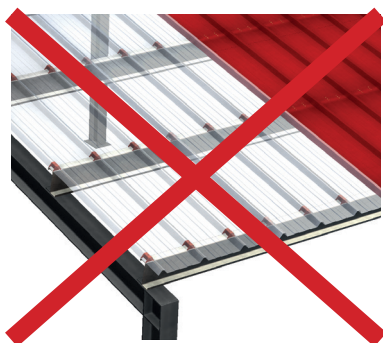
Interdit en rive
