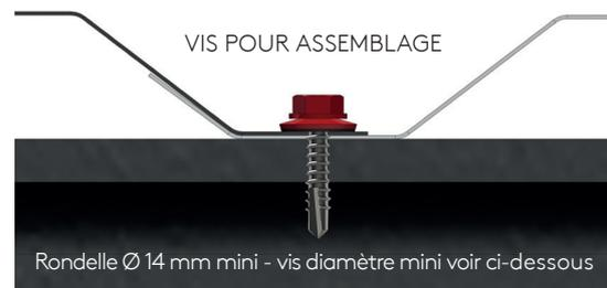
Les fixations doivent être adaptées à la nature des appuis et la densité de fixation adaptée aux charges de vent appliquées.
