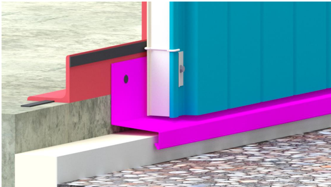
Pose avant emboîtement d'un cordon de mastic silicone à relier au complément d'étanchéité sur appui
