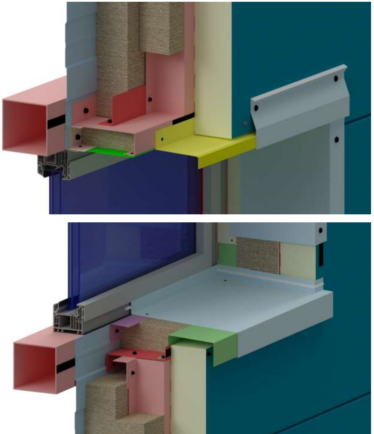
Figure 30 – BENCHMARK Korporate 2 avec pose horizontale des panneaux sandwich isolants – Exemple de baie (vues 3D)
