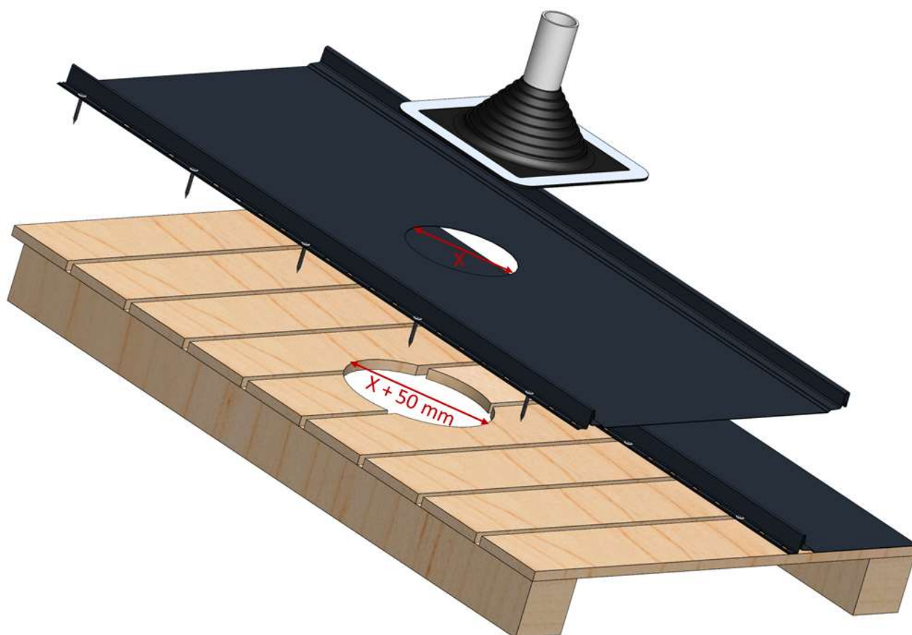
Figure 16 - Réserve dans volige bois pour manchon d'étanchéité
