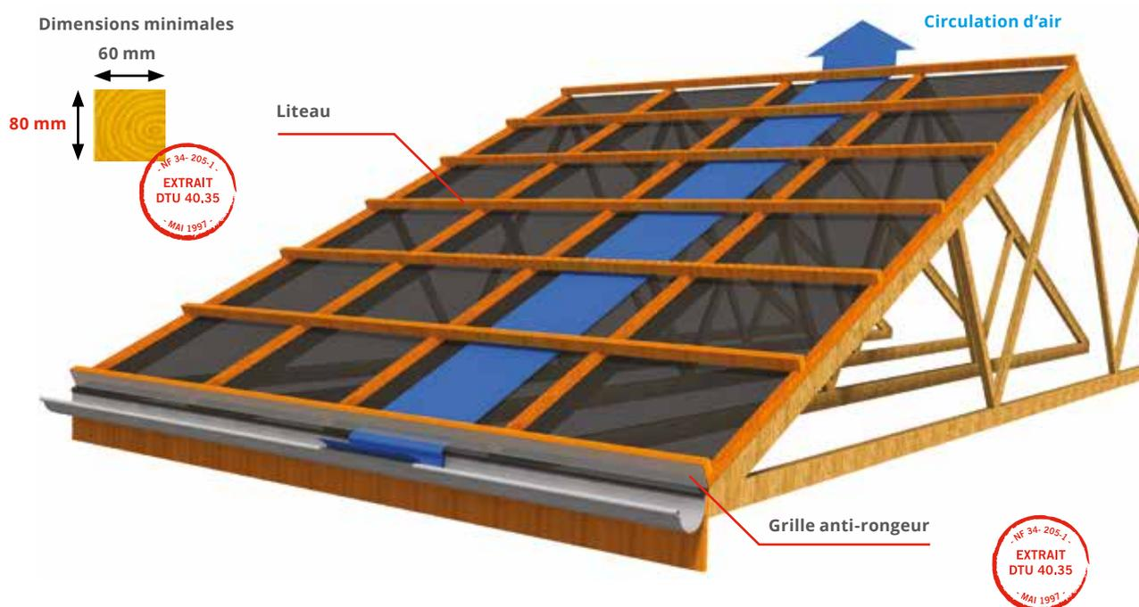
L'espace créé entre la face supérieure de l'écran de sous toiture et la face inférieure des liteaux assure une circulation d'air correcte. La ventilation doit être assurée par une lame d'air de 40 mm minimum.
