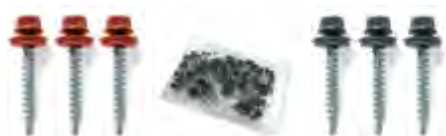
Vis autoperceuses 4,9 x 35 pour support bois
