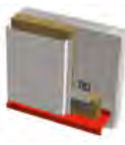
Bas de bardage à larmier
