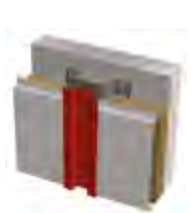
Jonction entre lames / à joint creux
